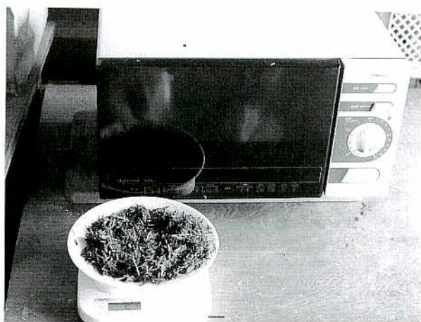
写真-3 電子レンジと料理計りで簡単水分測定
