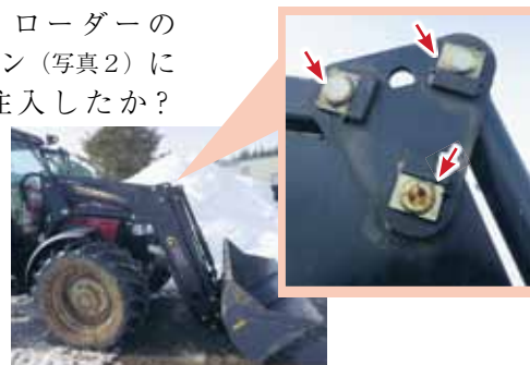
写真2 ローダーのアームのピン（一部）アームの内側からグリスを注入。簡単な作業なので、早めに実施してほしい（メーカーメカニック談）。
