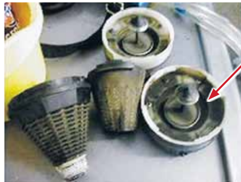
写真3 水洗い可能な調圧器
