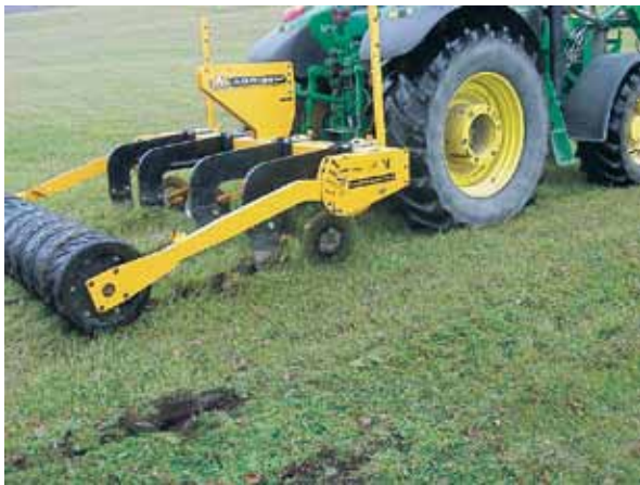
写真2 草地用サブソイラーによる切断の様子
