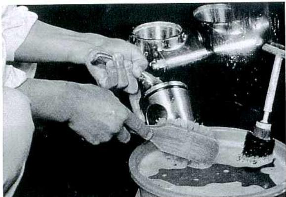
15 特に、見づらい箇所に汚れが付着しますので、カバーの裏面、攪拌器の羽根、搾乳パルプなどを十分洗いましょう。
